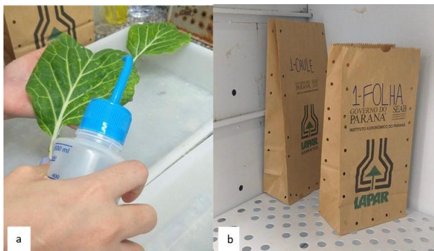
Figura 4 - Folhas de couve enxaguadas com água deionizada (a) e acondicionadas em saco de papel perfurados, acomodados na estufa com circulação forçada de ar a 65 °C (b). Londrina, PR. 2023.
