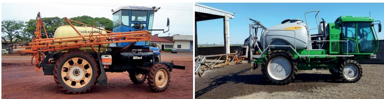
**Figura 14.** Pulverizadores de arrasto adaptados sobre chassi de tratores.
