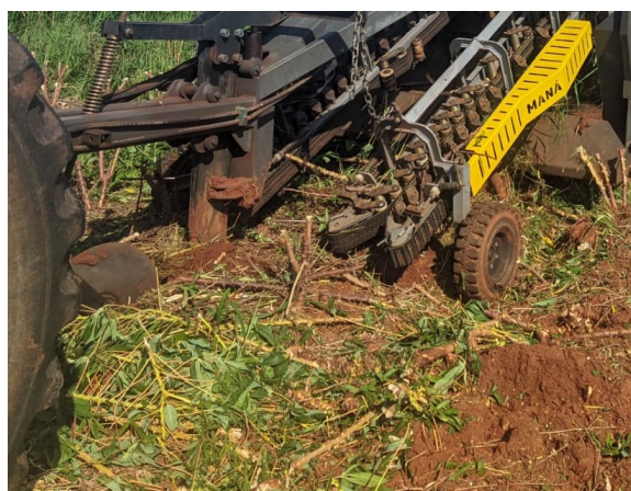
Figura 2. Sistema de esteiras que realizam o processo de arranquio das plantas.
