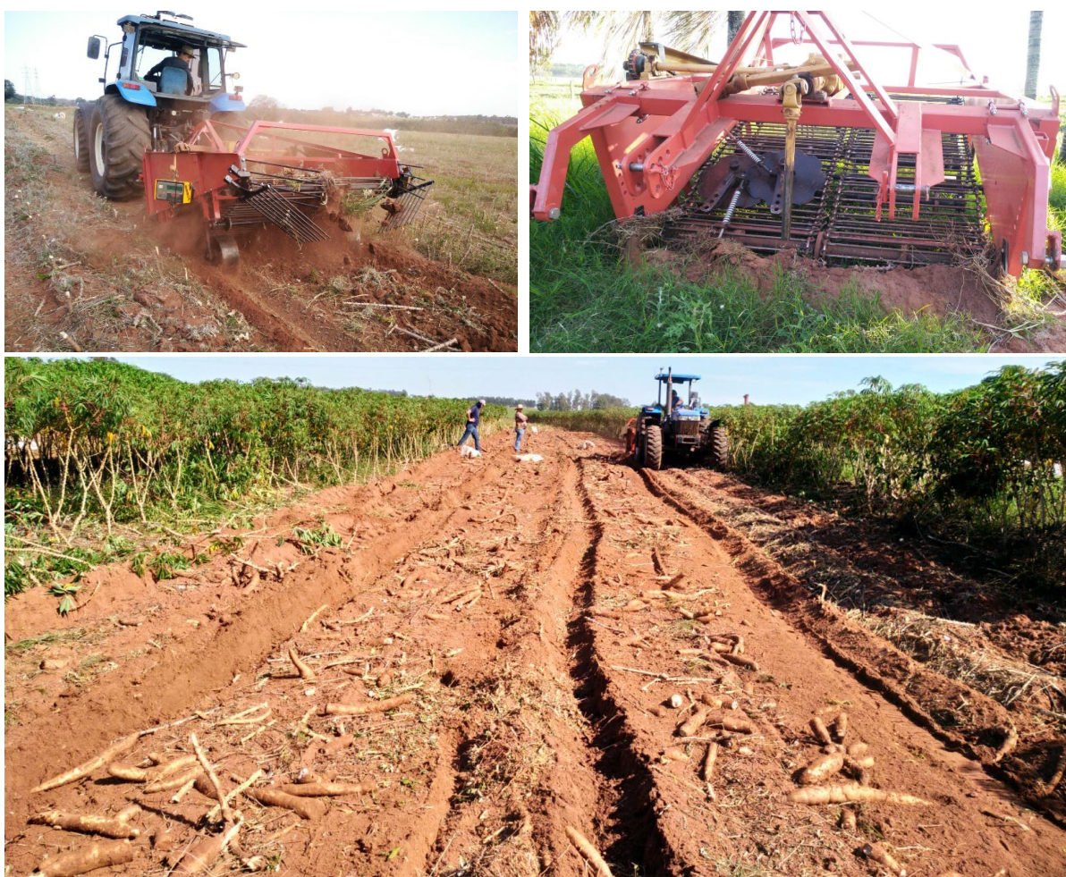
Figura 7. Máquina arrancadora para mandioca, conhecida como “batateira” e exposição das perdas não recuperáveis após a passagem da Maná.
