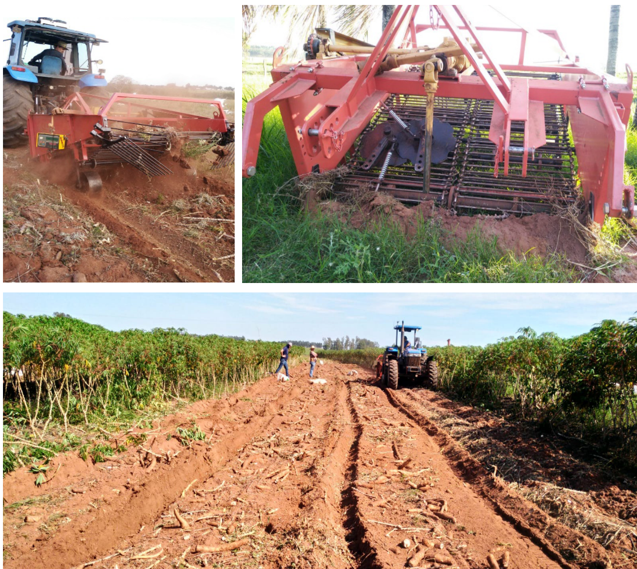
Figura 7. Máquina arrancadora para mandioca, conhecida como “batateira” e exposição das perdas não recuperáveis após a passagem da Maná.
