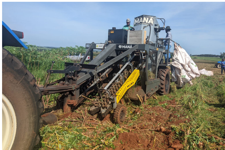
Figura 2. Sistema de esteiras que realizam o processo de arranquio das plantas.
