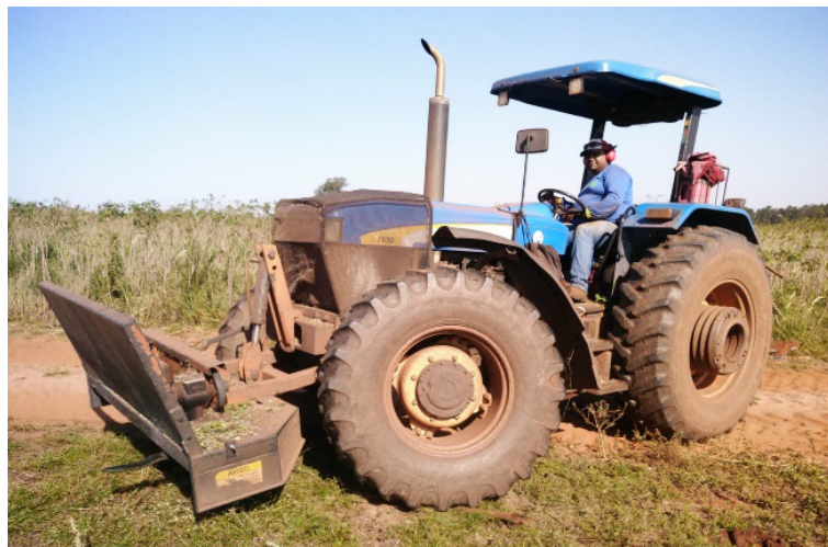
Figura 3. Podadora da parte aérea das plantas, acoplada na dianteira do trator agrícola.
